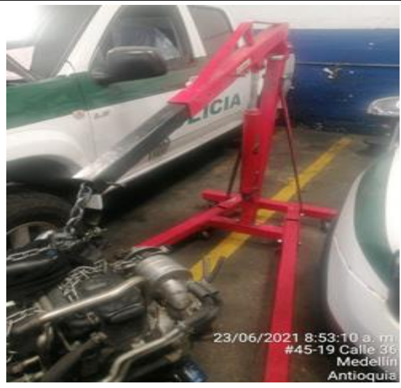
TORRE DIFERENCIAL PARA DESMONTE DE MOTORES
