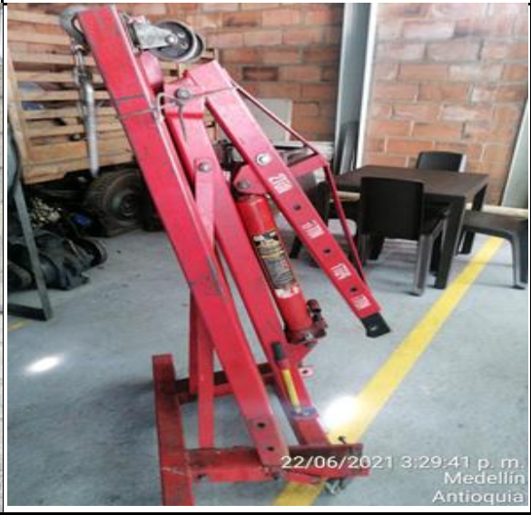
TORRE DIFERENCIAL PARA DESMONTE DE MOTORES
