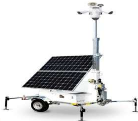
Gráfica 1: Tráiler, equipos de respaldo de energía, mástil y conjunto de cámaras
