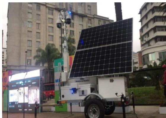
Ilustración 3 Sistema Inteligente de Monitoreo Móvil.
