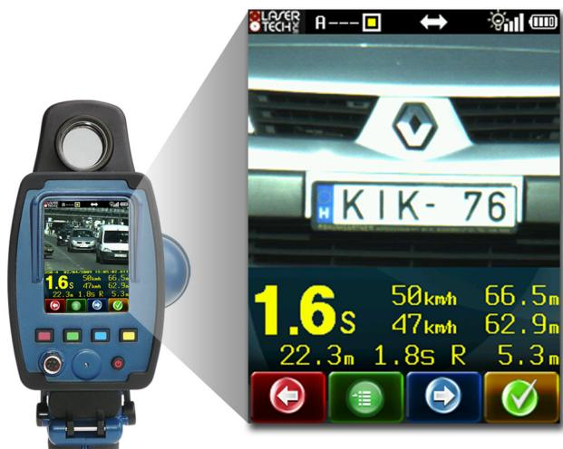
La TruCam es capaz de controlar distintas velocidades y a su vez, permite capturar a motocicletas. Esto permite derrotar a todos los infractores y ofrece el cifrado de los datos para asegurar que todas las evidencias siempre estén seguras.
