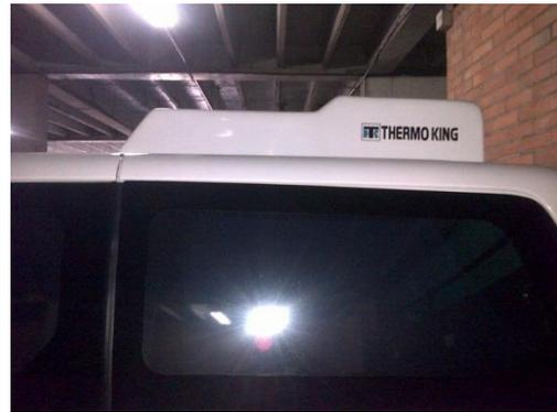
Aire acondicionado: Capacidad de 17.000 btu, distribuido en cabina y habitáculo, mediante derivación con evaporadores, funcionamiento de forma correcta.
