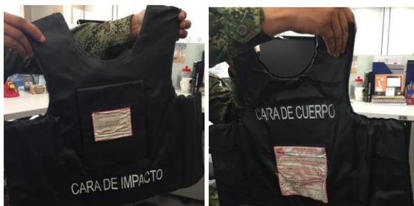
R// La lona es el material con el que es fabricado el contenedor de las placas.
