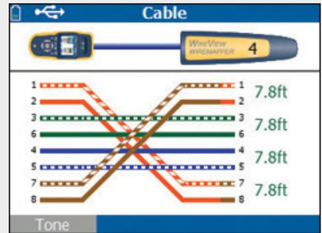
Un cable mal cableado con pares 1,2 y 7,8 intercambiados que utilizan el identificador de cable número 4.
